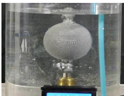
Configuración del ensayo para medir la estanqueidad al aire
