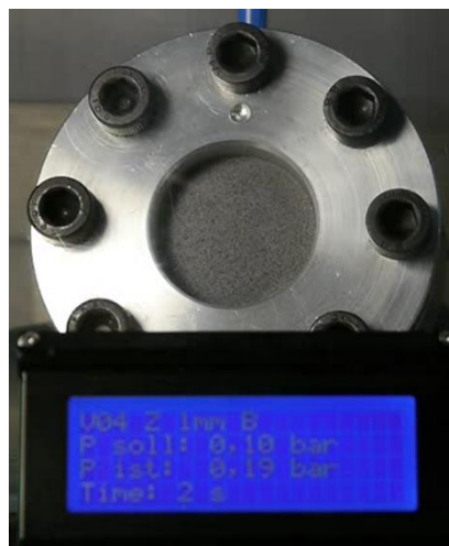
Configuración del ensayo para medir la presión de rotura
