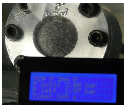
Configuración del ensayo para medir la estanqueidad al aire
