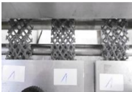
Configuración del ensayo de flexión Ross de Ultrasint® TPU01
