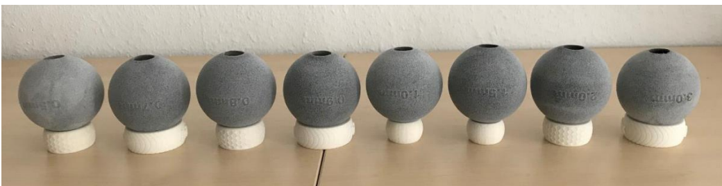
Condiciones de ensayo de la estanqueidad al agua con esferas huecas
