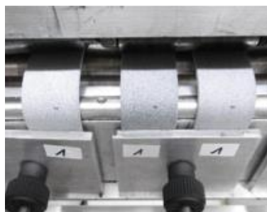
Configuración del ensayo de flexión Ross de Ultrasint® TPU01
