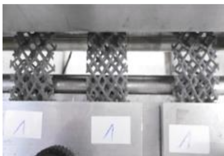
Konfiguracja testowa pomiaru zginania Ross termoplastycznego poliuretanu Ultrasint® TPU01
