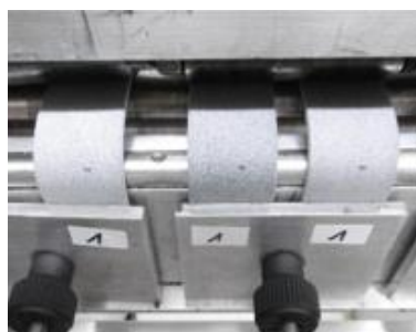
Konfiguracja testowa pomiaru zginania Ross termoplastycznego poliuretanu Ultrasint® TPU01
