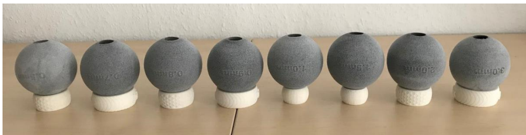
Warunki testowania szczelności za pomocą pustych kul
