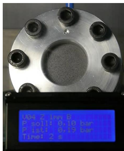
Configurazione del test per misurare la pressione di rottura
