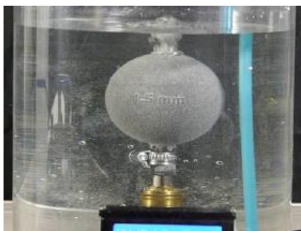
Configurazione del test per misurare l'impermeabilità all'aria
