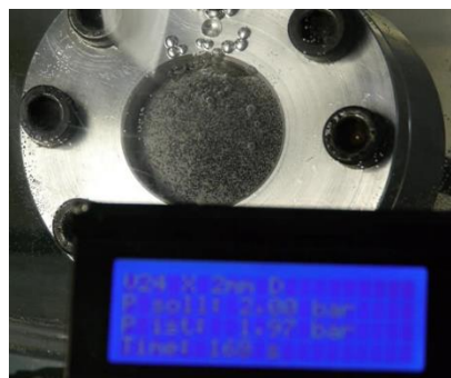
Configurazione del test per misurare l'impermeabilità all'aria
