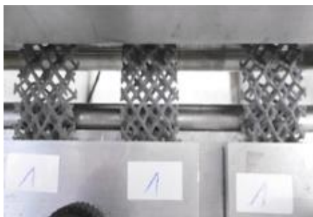
Configurazione del test di flessione Ross di Ultrasint® TPU01
