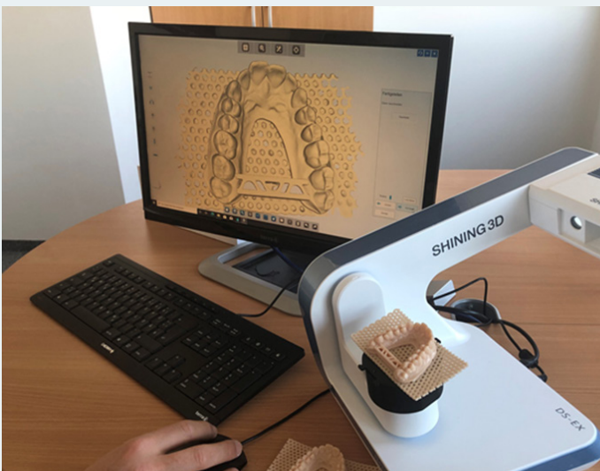
Abb. 11: Scan der gedruckten Modelle mit dem Shining 3D® Autoscan DS EX Pro S (Quelle: Organical CAD/CAM)
