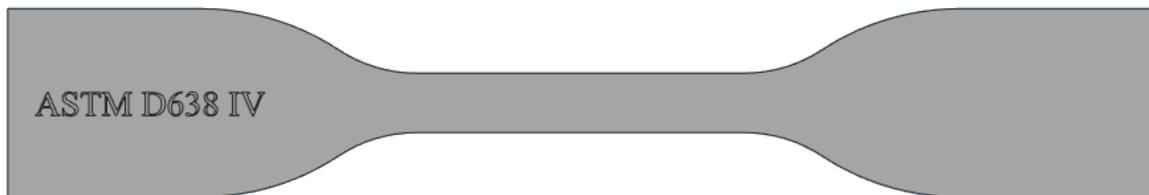
*Figure 1 Tensile Bar*
