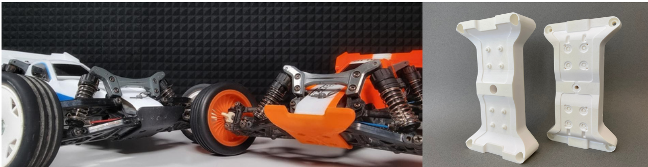
Stoßstangen aus PA (schwarz) und PP GF30 (orange) links, das dazugehörige Zweifach-Tool (rechts). Bilder © DREIGEIST
