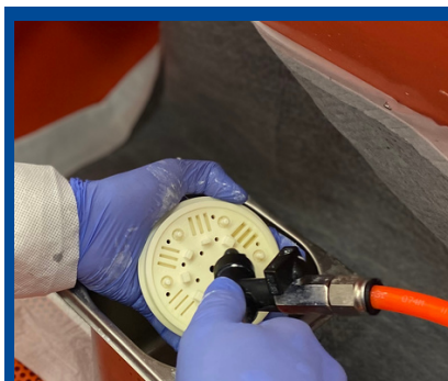
Ausblasen mit Druckluft
