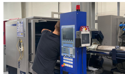
Einbau der Tools
