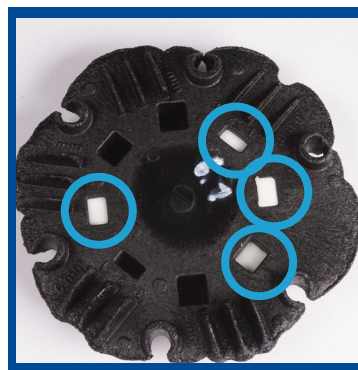
SG-Bauteil B, gebrochenes Tool hatte 5 Minuten IPA-Kontakt
